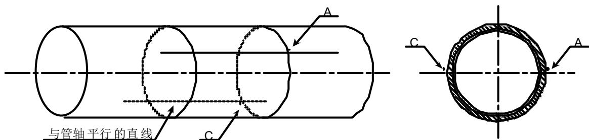
五、去掉定位纸，从点 C 开始，在所划直线上量出安装距离 L，从而决定出 B 点。这样 A、B 两点为安装位置；例如  $L=280mm$ ，将球阀底座分别焊接在 A 和 B 两点上，注意球阀座中心点一定要分别与 A 和 B 两点重合。心点一定要分别与 A 和 B 两点重合。
