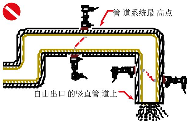
4、对于开口或半满管的管道，流量计应安装在 U型管段处。
