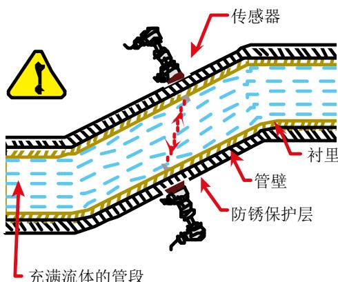
2、安装点应选择上游大于 10 倍直管径、下游大于 5 倍直管径以内无任何阀门、弯头、变径等均匀的直管段，安装点应充分远离阀门、泵、高压电和变频器等干扰源。
