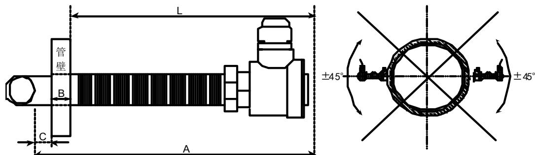
接线完毕后, 锁紧进线孔螺母 (注意密封垫不要丢失), 最后拧紧密封盖, 防止漏水。
