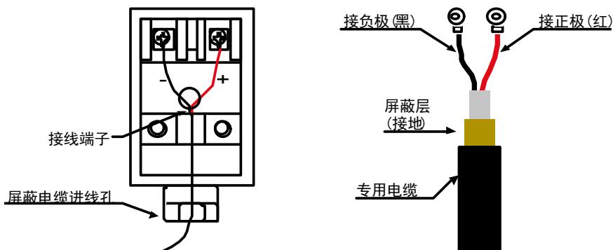
2、密封防水, 接好线后必须用密封胶 (耦合剂) 注满, 盖好盖后, 必须将传感器屏蔽线缆进线孔拧好锁紧, 以防进水;
