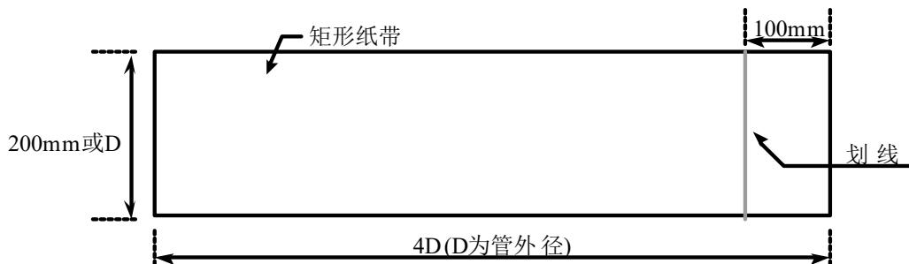
二、将定位纸缠绕在表面已清理干净的管道上，注意必须把纸两边互相重合对齐，才能使所划的线与管轴相平行；
