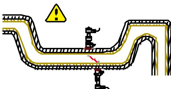
5、两个传感器必须安装在管道轴面的水平方向上，并且在轴线水平位置±45°范围内安装，以防止上部有不满管、气泡或下部有沉淀等现象影响传感器正常测量。如果受安装地点空间的限制而不能水平对称安装时，可在保证管内上部分无气泡的条件下，垂直或有倾角地安装传感器。
