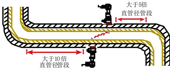
3、避免安装在管道系统的最高点或带有自由出口的竖直管道上（流体向下流动）
