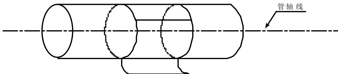
三、延长定位纸上的直线在管道上划一直线，所划直线与定位纸一边缘相交点为 A；
