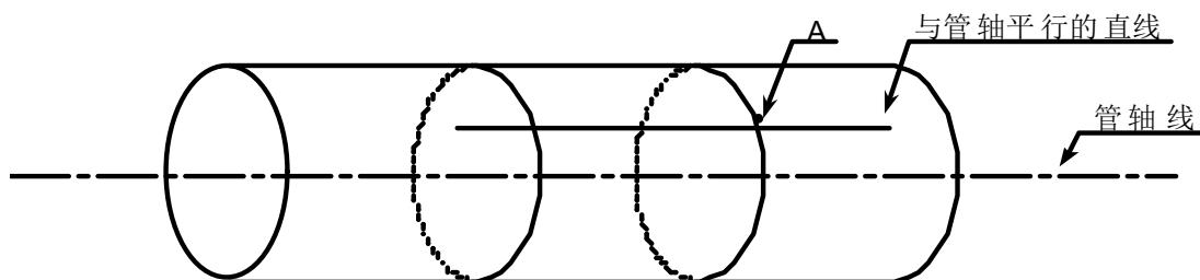
四、从 A 点开始，沿着定位纸边边缘量出管道  $1/2$  周长，该平行交叉点为 C，在 C 点划一条与管轴平行的直线（也就是与定位纸上的直线平行）；
